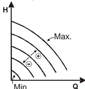
La velocità di rotazione è mantenuta ad un numero di giri costante. Tale velocità di rotazione può essere impostata fra un valore minimo e la frequenza nominale della pompa di circolazione (ad es. fra 15 Hz e 50 Hz).
