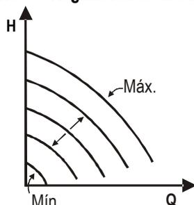
Se mantiene la velocidad de rotación con un número de revoluciones constante proporcionalmente a la tensión de la señal analógica externa (ver el párr. 5.5.2). La velocidad de rotación varía de forma lineal entre la frecuencia nominal de la bomba cuando  $V_{in} = 10V$  y la frecuencia mínima cuando  $V_{in} = 0V$ . Es posible programar este modo con el panel de control situado en la tapa del MCE-22/C (ver párr. 9).
