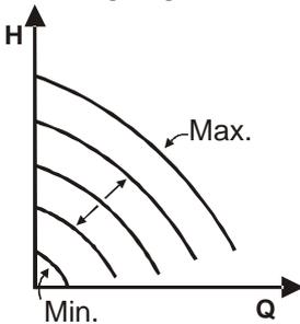
De draaisnelheid wordt op een constant toerental gehouden, proportioneel aan de spanning van het externe analoge signaal (zie par. 5.5.2). De draaisnelheid varieert lineair tussen de nominale frequentie van de pomp wanneer  $V_{in} = 10V$  en de minimumfrequentie wanneer  $V_{in} = 0V$ .
