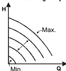
Rotationshastigheten hålls vid ett jämnt varvtal som är proportionellt med den externa analoga signalens spänning (se kap. 5.5.2). Rotationshastigheten varierar linjärt mellan pumpens märkfrekvens när  $V_{in} = 10\text{ V}$  och min. frekvens när  $V_{in} = 0\text{ V}$ .
