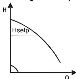
La altura de descarga permanece constante, independientemente del requerimiento de agua. Es posible programar este modo con el panel de control situado en la tapa del MCE-22/C (ver párr. 9).
