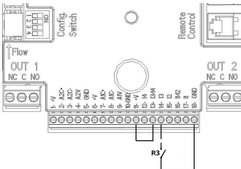
Figura 5: Ejemplo de conexión entrada digital Quick Start
