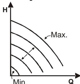
La velocità di rotazione è mantenuta ad un numero di giri costante proporzionalmente alla tensione del segnale analogico esterno (si veda par. 5.5.2). La velocità di rotazione varia in modo lineare fra la frequenza nominale della pompa quando  $V_{in} = 10V$  e la frequenza minima quando  $V_{in} = 0V$ .
