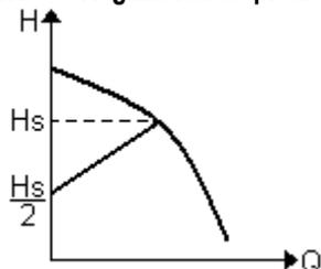
Con este modo de regulación se aumenta o disminuye la presión diferencial al disminuir o aumentar el requerimiento de agua. Se configura este modo a través del panel de control situado en la tapa de MCE-22/C (ver apart. 9).
