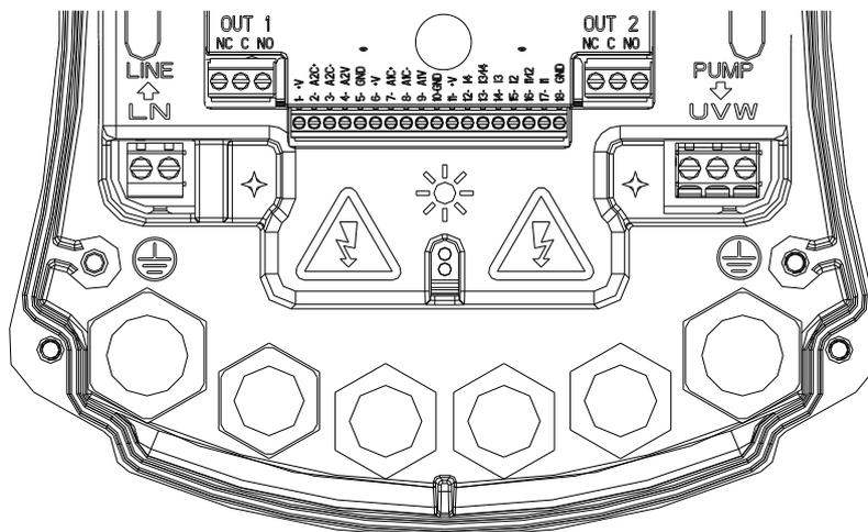
*Afbeelding 1: Elektrische aansluitingen*
