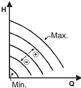
De draaisnelheid wordt op een constant toerental gehouden. Deze draaisnelheid kan worden ingesteld tussen een minimumwaarde en de nominale frequentie van de circulatiepomp (bijv. tussen 15 Hz en 50 Hz).
