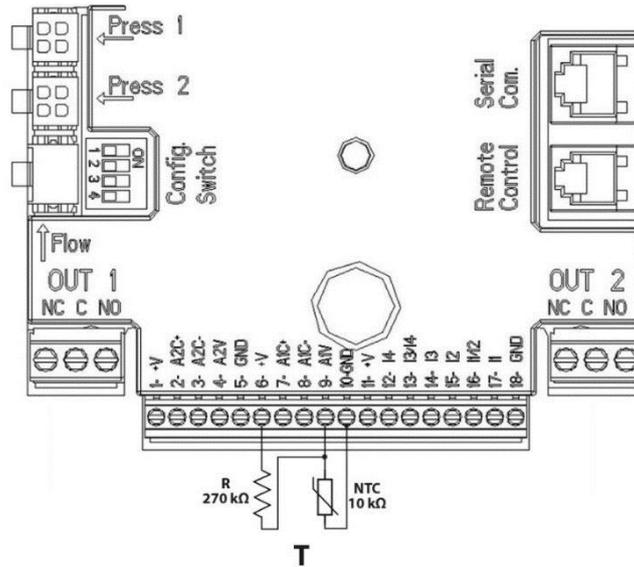
Figura 8: Conexiune senzor NTC pentru măsurarea temperaturii T
