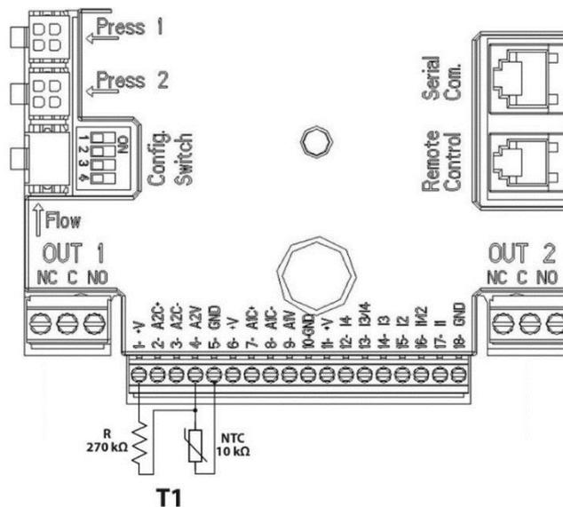
*Figura 7: Conexiune senzor NTC pentru măsurarea temperaturii T1*
