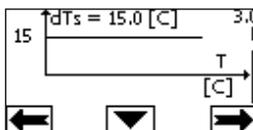
В этом случае циркуляционный насос увеличивает или уменьшает скорость потока чтобы сохранить абсолютную разницу между  $T$  и  $T_1$  при  $dTs = 15 \text{ }^\circ\text{C}$ .
