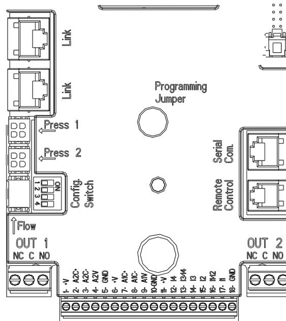
Figura 3: Conexiones
