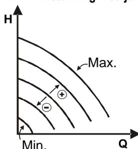
Rotationshastigheten hålls vid ett jämnt varvtal. Denna rotationshastighet kan ställas in mellan ett min. värde och cirkulationspumpens märkfrekvens (t.ex. mellan 15 och 50 Hz).
