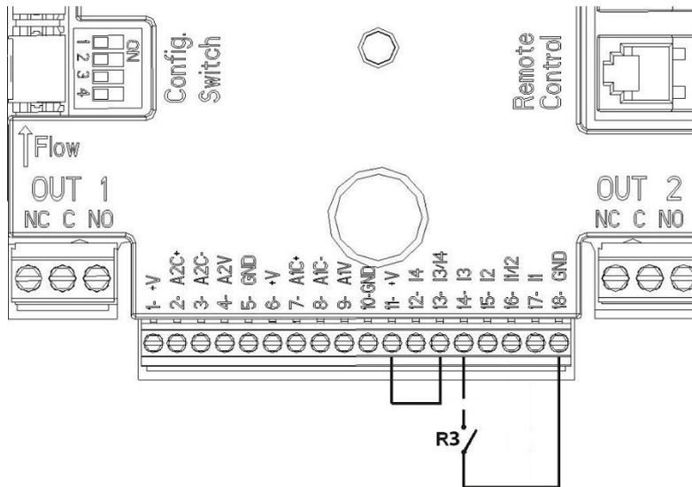
5 ábra: Quick Start Digitális bemeneti bekötési példa
