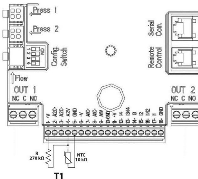
Фиг. 7: Свързване на NTC сензор за измерване на температурата Т1
