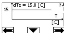
En este caso el circulador aumenta o disminuye el caudal para mantener constante en  $dTs = 15\text{ °C}$  la diferencia absoluta entre  $T$  y  $T_1$
