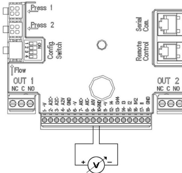
*Figura 6: Ejemplo de conexión de entrada analógica*
