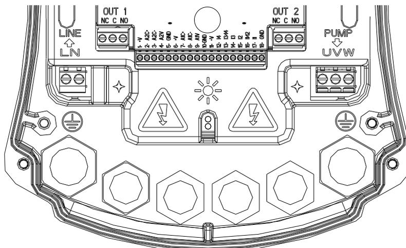
Figure 1: Connexions électriques
