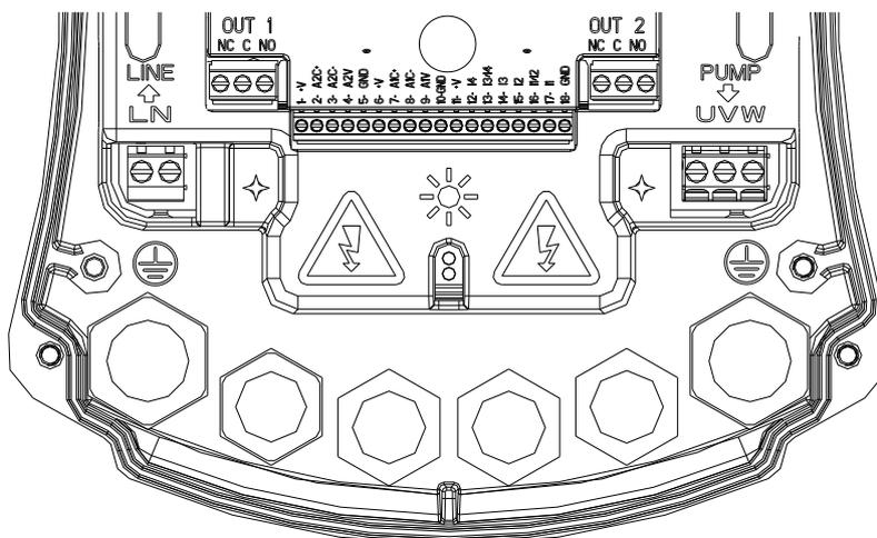
Figura 1: Connessioni Elettriche
