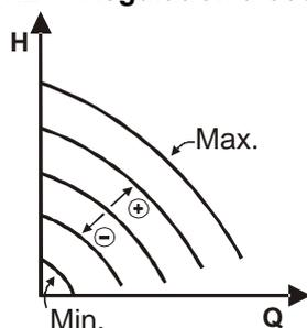
La vitesse de rotation est maintenue à un nombre de tours constant. Cette vitesse de rotation peut être configurée entre une valeur minimum et la fréquence nominale de la pompe de circulation (par ex. entre 15 Hz et 50 Hz).
