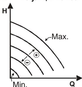
Скорость вращения поддерживается постоянным числом оборотов. Такая скорость вращения может быть задана от минимального значения до номинальной частоты циркуляционного насоса (например, от 15 Гц до 50 Гц).
