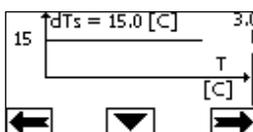
In diesem Fall erhöht oder verringert die Umlaufpumpe den Durchsatz, um den absoluten Unterschied zwischen  $T$  und  $T_1$  konstant auf  $dTs = 15 \text{ °C}$  beizubehalten.
