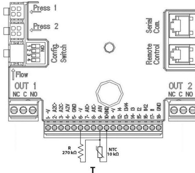
Figura 8: Conexión sensor NTC para medición temperatura T
