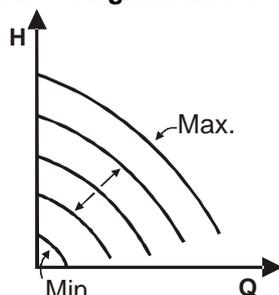
La vitesse de rotation est maintenue à un nombre de tours constant proportionnellement à la tension du signal analogique externe (voir par. 0). La vitesse de rotation varie de manière linéaire entre la fréquence nominale de la pompe quand  $V_{in} = 10\text{ V}$  et la fréquence minimum quand  $V_{in} = 0\text{ V}$ .
