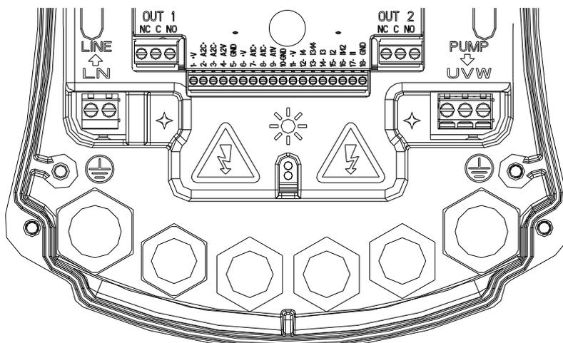
Figura 1: Conexiuni Electrice
