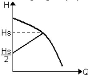
In deze regelmodus wordt de verschildruk verlaagd of verhoogd naarmate de vraag om water af- of toeneemt.
