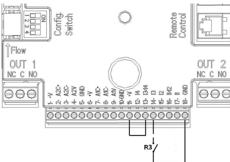
Figura 5: Exemplu Conexiune Intrare Digitală Quick Start
