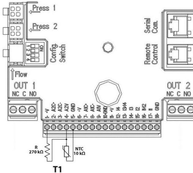
Resim 7: T1 sıcaklık ölçümü için NTC sensör bağlantısı
