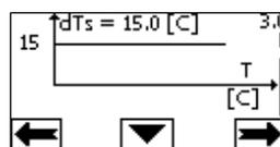
In dit geval verhoogt of verlaagt de circulatiepomp het debiet om het absolute verschil tussen  $T$  en  $T_1$  constant te houden op  $dTs = 15 \text{ °C}$ .
