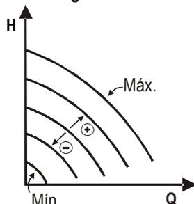
Se mantiene la velocidad de rotación con un número de revoluciones constante. Es posible configurar dicha velocidad de rotación entre un valor mínimo y la frecuencia nominal de la bomba de circulación (por ej., entre 15 Hz y 50 Hz). Es posible programar este modo con el panel de control situado en la tapa del MCE-22/C (ver párr. 9).
