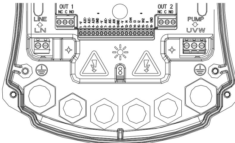
Abbildung 1: Elektroanschlüsse
