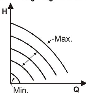
Die Drehgeschwindigkeit wird auf einer konstanten Drehzahl gehalten, die proportional zur Spannung des externen Analogsignals ist (siehe Abs.5.5.2). Die Drehgeschwindigkeit variiert linear zwischen der Nennfrequenz, wenn  $V_{in} = 10V$  und der Mindestfrequenz der Pumpe, wenn  $V_{in} = 0V$ .
