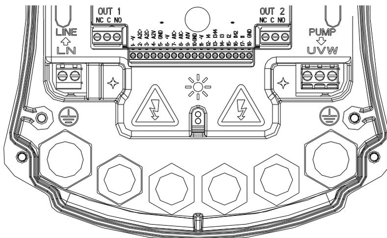
Σχήμα 1: Ηλεκτρική Συνδεσμολογία
