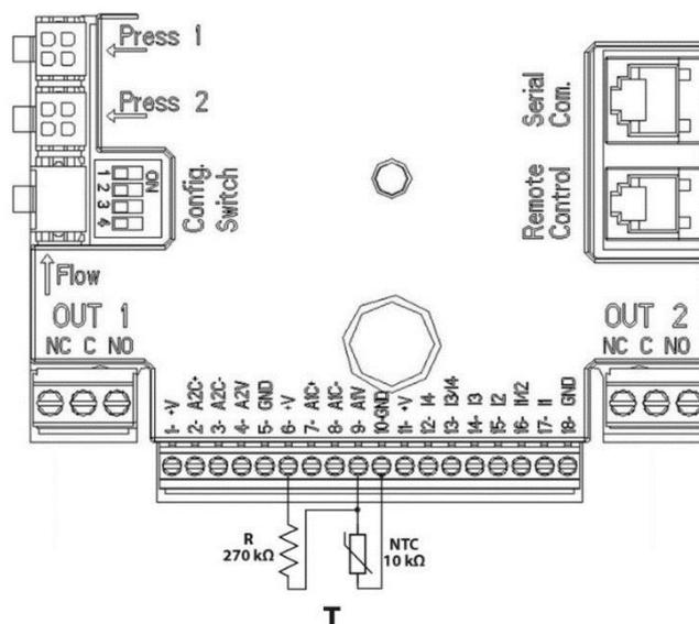
Figura 8: Collegamento sensore NTC per misura temperatura T
