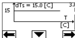
Στην περίπτωση αυτή ο κυκλοφορητής αυξάνει ή μειώνει την παροχή έτσι ώστε να διατηρείται σταθερή στους  $dTs = 15 \text{ }^\circ\text{C}$  η απόλυτη διαφορά μεταξύ  $T$  και  $T_1$
