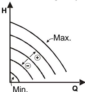
Rotationshastigheten hålls vid ett jämt varvtal. Denna rotationshastighet kan ställas in mellan ett min. värde och cirkulationspumpens märkfrekvens (t.ex. mellan 15 och 50 Hz).
