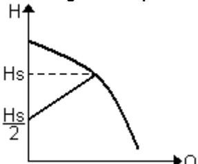
Dans cette modalité de réglage la pression différentielle est réduite ou augmentée quand la demande d'eau diminue ou augmente.
