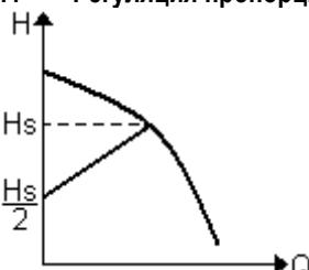
В этом режиме настройки дифференциальное давление сокращается или повышается при сокращении или повышении водоразбора.
