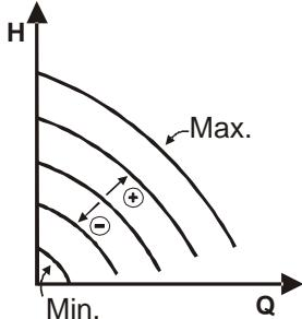
De draaisnelheid wordt op een constant toerental gehouden. Deze draaisnelheid kan worden ingesteld tussen een minimumwaarde en de nominale frequentie van de circulatiepomp (bijv. tussen 15 Hz en 50 Hz).
