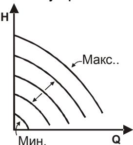
Скоростта на въртене се запазва постоянна, пропорционално на големината на напрежението на аналоговия сигнал (виж пар. 5.5.2). Скоростта варира по линеен закон между ограничителната честота на помпата когато  $V_{in} = 10V$  и минимална честота когато  $V_{in} = 0V$ .
