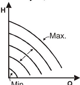
Скорость вращения поддерживается постоянным числом оборотов пропорционально напряжению внешнего аналогового сигнала (см. парагр. 5.5.2). Скорость вращения варьирует линейно от номинальной частоты насоса, когда  $V_{in} = 10$  В, и минимальной частотой, когда  $V_{in} = 0$  В.
