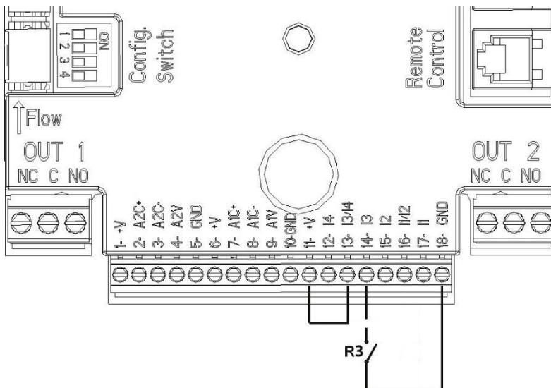
Figura 5: Esempio Collegamento Ingresso Digitale Quick Start
