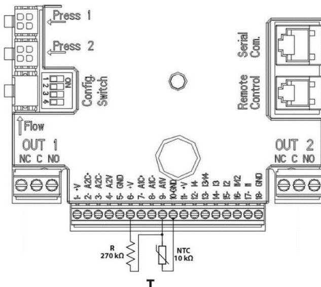
Resim 8: T sıcaklık ölçümü için NTC sensör bağlantısı
