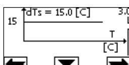
Bu durumda sirkülatör, T ve T1 arasındaki mutlak farkı  $dTs = 15^\circ\text{C}$  olarak sabit tutmak için debiyi artırır veya azaltır
