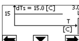
Dans ce cas, le circulateur augmente ou diminue le débit pour maintenir constante la différence absolue entre T et T1 à  $dTs = 15^\circ C$ .
