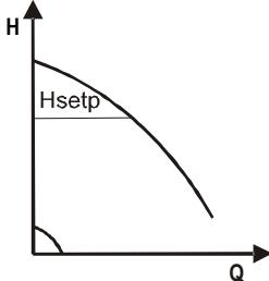
La altura de descarga permanece constante, independientemente del requerimiento de agua. Es posible programar este modo con el panel de control situado en la tapa del MCE-150/C (ver párr. 9 ).
