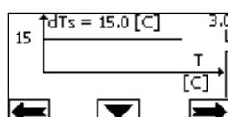
В этом случае циркуляционный насос увеличивает или уменьшает скорость потока чтобы сохранить абсолютную разницу между  $T$  и  $T1$  при  $dTs = 15^{\circ}\text{C}$
