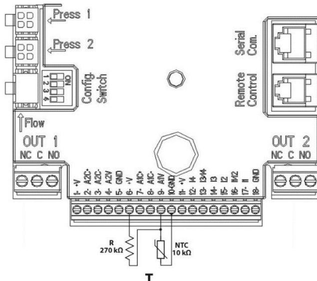
8.ábra: A T1 hőmérséklet méréséhez szükséges NTC szenzor bekötése
