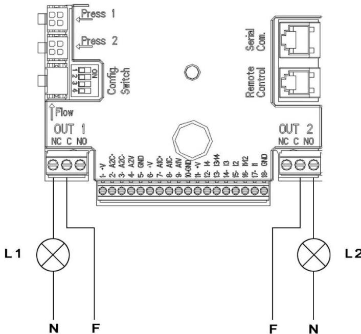
Figure 9: Exemple connexion sorties logiques
