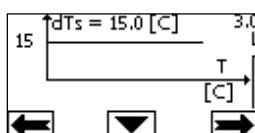
En este caso el circulador aumenta o disminuye el caudal para mantener constante en  $dTs = 15^\circ\text{C}$  la diferencia absoluta entre  $T$  y  $T1$ .
