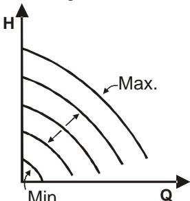
Viteza de rotare este menținută la un număr de rotații constant proporțional cu tensiunea semnalului analogic extern (a se vedea paragraful 5.5.2). Viteza de rotare variază în mod linear între frecvența nominală a pompei când  $V_{in} = 10V$  și frecvența minimă când  $V_{in} = 0V$ . Această modalitate poate să fie setată prin intermediul panoului de control amplasat pe capacul MCE-150/C (a se vedea paragraful 9).
