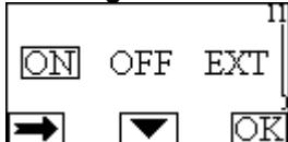
Op pagina 11.0 kan het systeem in de status ON, OFF of EXT (bediend door een signaal van afstand) worden gebracht (Digitale ingang I1).
