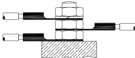
Figura 2: Conexión de tierra
