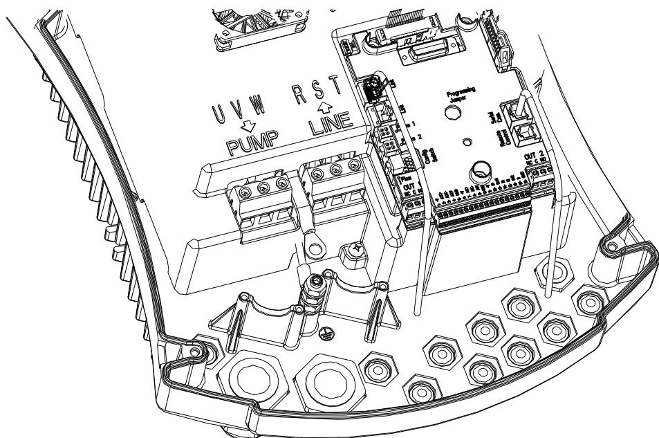
*Figura 1: Conexiuni Electrice*
