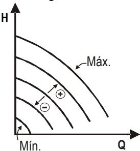
Se mantiene la velocidad de rotación con un número de revoluciones constante. Es posible configurar dicha velocidad de rotación entre un valor mínimo y la frecuencia nominal de la bomba de circulación (por ej., entre 15 Hz y 50 Hz).
