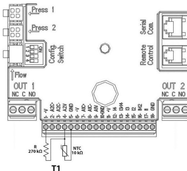
7.ábra A T1 hőmérséklet méréséhez szükséges NTC szenzor bekötésec
