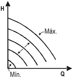
Se mantiene la velocidad de rotación con un número de revoluciones constante proporcionalmente a la tensión de la señal analógica externa (ver el párr. 5.5.2). La velocidad de rotación varía de forma lineal entre la frecuencia nominal de la bomba cuando  $V_{in} = 10V$  y la frecuencia mínima cuando  $V_{in} = 0V$ .
