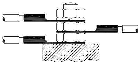
*Abbildung 2: Erdungsanschluss*
