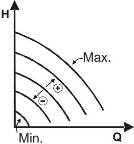
Die Drehgeschwindigkeit wird auf einer konstanten Drehzahl gehalten. Diese Drehgeschwindigkeit kann zwischen einem Mindestwert und der Nennfrequenz der Umwälzpumpe eingestellt werden (z.B. zwischen 15 Hz und 50 Hz).
