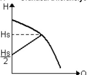
Bu ayarlama yönteminde diferansiyel basınç, su talebinin azalmasına veya artmasına göre azaltılır veya arttırılır.
