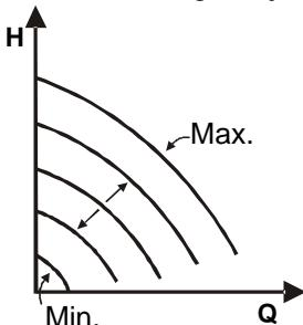
Rotationshastigheten hålls vid ett jämt varvtal som är proportionellt med den externa analoga signalens spänning (se kap. 5.5.2). Rotationshastigheten varierar linjärt mellan pumpens märkfrekvens när  $V_{in} = 10$  V och min. frekvens när  $V_{in} = 0$  V.
