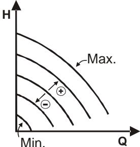
Viteza de rotație este menținută la un număr de rotații constant. O astfel de viteză poate fi setată între o valoare minimă și frecvența pompei de circulare (de ex. între 15 Hz și 50 Hz). Această modalitate poate să fie setată prin intermediul panoului de control amplasat pe capacul MCE-150/C (a se vedea paragraful 9).
