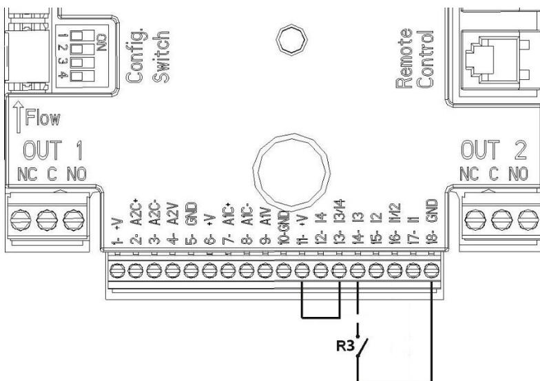
Σχήμα 5: Παράδειγμα Σύνδεσης Ψηφιακής εισόδου Ταχείας εκκίνησης
