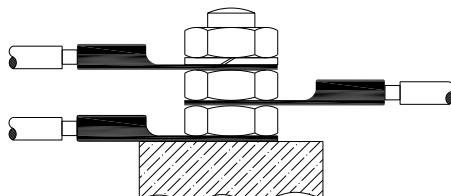
Σχήμα 2: Σύνδεση Γείωσης
