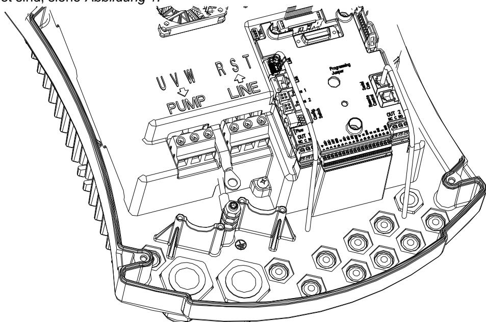
Abbildung 1: Elektroanschlüsse
