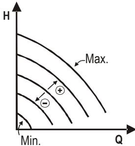
V tem načinu krmiljenja se hitrost vrtenja vzdržuje s konstantnim številom vrtljajev. Hitrost vrtenja se lahko nastavi med minimalno vrednostjo in nominalno frekvenco obtočne črpalke (na primer med 15Hz in 50Hz).
