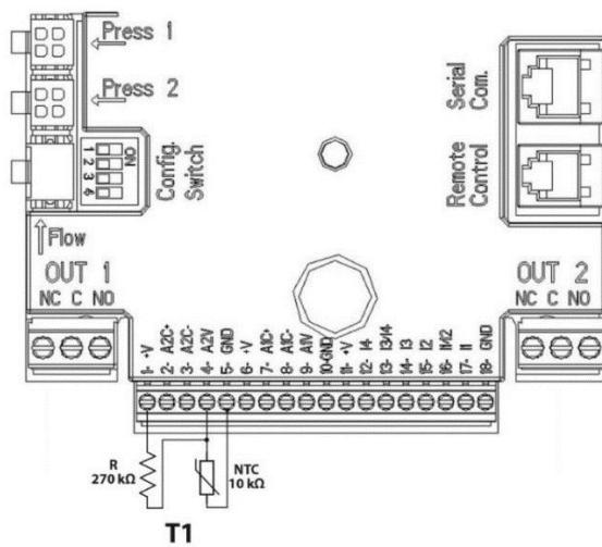
Σχήμα 7: Σύνδεση αισθητήρα NTC για μέτρηση της θερμοκρασίας Τ1
