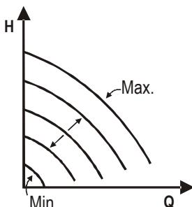
V tem načinu krmiljenja se hitrost vrtenja vzdržuje s konstantnim številom vrtljajev v odvisnosti od napetosti zunanjega analognega signala (glejte **točko 5.5.2.**). Hitrost vrtenja se spreminja linearno med nominalno frekvenco obtočne črpalke (ko je  $V_{in} = 10V$ ) in minimalno frekvenco obtočne črpalke (ko je  $V_{in} = 0V$ ).
