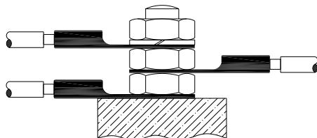
*Figura 2: Connessione Di Terra*
