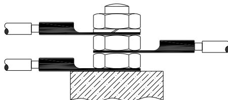
Схема 2: Подсоединение заземления
