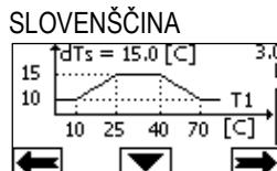
1) Če je  $T_1 \leq 10^\circ\text{C} \Rightarrow dTs = |T - T_1| = 10^\circ\text{C}$
