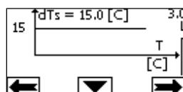
Ilyen esetben cirkulátor csökkenti vagy növeli a folyadékmennyiséget, így konstans marad a  $dTs = 15^{\circ}\text{C}$ . T alatt, a T és T1 közötti abszolút különbség értendő.
