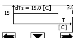
I detta fall ökar eller minskar cirkulationspumpen flödet för att upprätthålla den absoluta skillnaden mellan  $T$  och  $T1$  jämnt på  $dTs = 15^\circ\text{C}$ .
