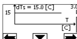
In diesem Fall erhöht oder verringert die Umwälzpumpe den Durchsatz, um den absoluten Unterschied zwischen  $T$  und  $T_1$  konstant auf  $dTs = 15^\circ\text{C}$  beizubehalten.
