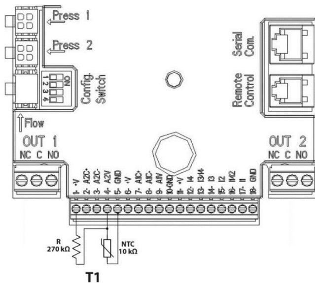
*Figura 7: Conexión sensor NTC para medición temperatura T1*
