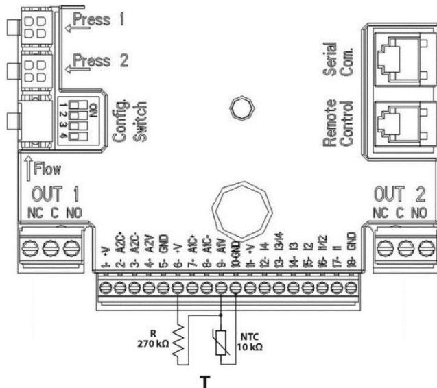
Slika 8: Povezava senzorja NTC za merjenje temperature T
