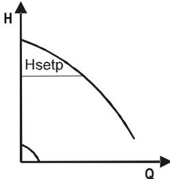
La altura de descarga permanece constante, independientemente del requerimiento de agua. Es posible programar este modo con el panel de control situado en la tapa del MCE-55/C (ver párr. 9 ).
