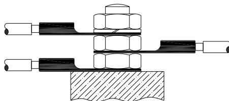
Схема 2: Подсоединение заземления
