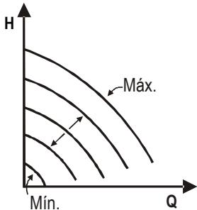
Se mantiene la velocidad de rotación con un número de revoluciones constante proporcionalmente a la tensión de la señal analógica externa (ver el párr. 5.5.2). La velocidad de rotación varía de forma lineal entre la frecuencia nominal de la bomba cuando  $V_{in} = 10V$  y la frecuencia mínima cuando  $V_{in} = 0V$ .
