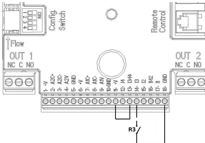
Obrázek 5: Příklad propojení na digitální vstup Quick Start
