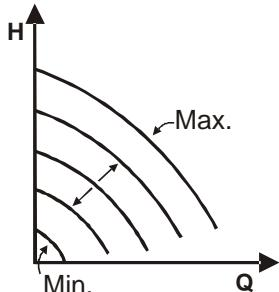
La vitesse de rotation est maintenue à un nombre de tours constant proportionnellement à la tension du signal analogique externe (voir par. 5.5.2). La vitesse de rotation varie de manière linéaire entre la fréquence nominale de la pompe quand  $V_{in} = 10$  V et la fréquence minimum quand  $V_{in} = 0$  V.
