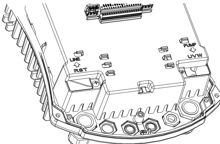
Figura 1: Conexiuni Electrice
