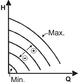
Rychlosť otáček je udržována na konstantním počtu otáček. Tato rychlosť otáček může být nastavena mezi minimální hodnotou a jmenovitou frekvencí oběhového čerpadla (např. mezi 15 Hz a 50 Hz).
