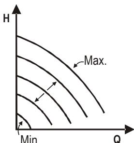
V tem načinu krmiljenja se hitrost vrtenja vzdržuje s konstantnim številom vrtljajev v odvisnosti od napetosti zunanjega analognega signala (glejte **točko 5.5.2.**). Hitrost vrtenja se spreminja linearno med nominalno frekvenco objačne črpalke (ko je  $V_{in} = 10V$ ) in minimalno frekvenco objačne črpalke (ko je  $V_{in} = 0V$ ).
