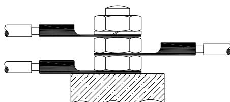
*Figura 2: Conexión de tierra*
