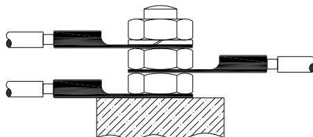
Σχήμα 2: Σύνδεση Γείωσης
