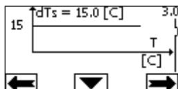
В этом случае циркуляционный насос увеличивает или уменьшает скорость потока чтобы сохранить абсолютную разницу между  $T$  и  $T_1$  при  $dTs = 15^\circ\text{C}$ .
