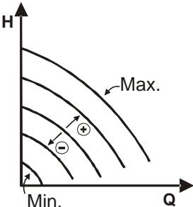
A fordulatszám állandó értéken van tartva. Ez a fordulatszám beállítható a keringető szivattyú minimális és névleges frekvenciája közötti érték szerint. (pl.: 15 Hz és 50 Hz közé).
