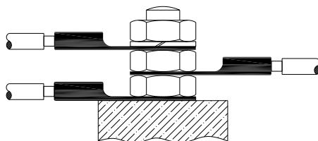
*Abbildung 2: Erdungsanschluss*
