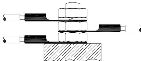
*Figura 2: Connessione Di Terra*
