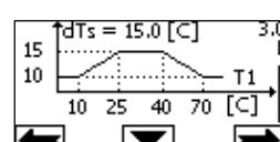
1) Če je  $T_1 \leq 10^\circ\text{C} \Rightarrow dTs = |T-T_1| = 10^\circ\text{C}$
