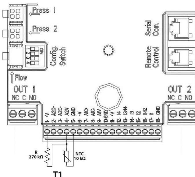
Abbildung 7: Anschluss NTC-Sensor für Temperaturmessung T1
