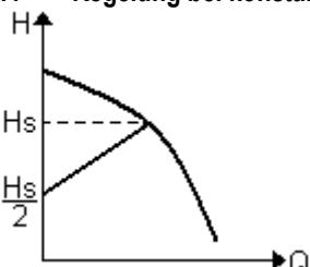
Bei diesem Einstellmodus wird der Differentialdruck je nach verringertem oder erhöhtem Wasserbedarf gesenkt oder erhöht.
