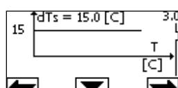
V tomto případě zvýší nebo sníží výkon za účelem udržet konstantní  $dTs = 15^{\circ}\text{C}$ , absolutní hodnota rozdílu mezi T a T1.
