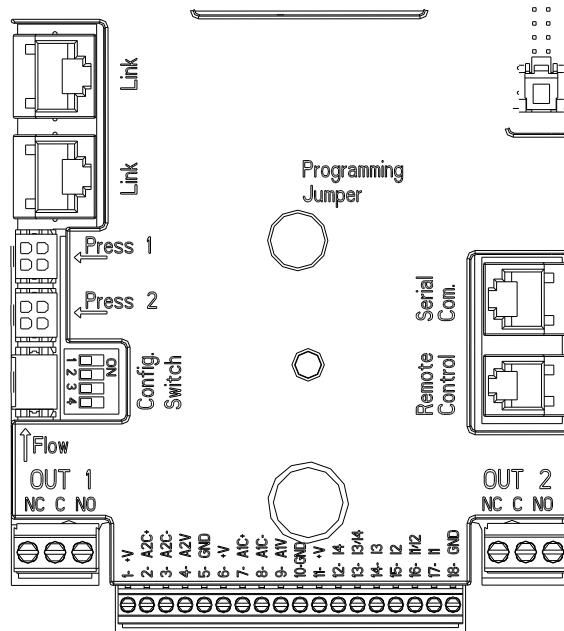
Figura 3: Conexiones
