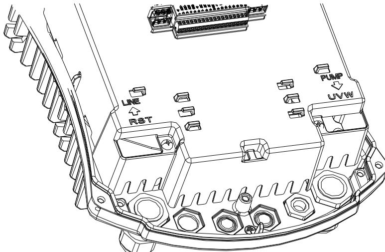
Фиг. 1: Електрически връзки
