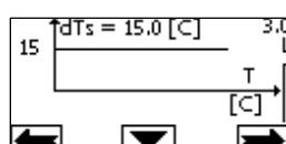
În acest caz circulatorul mărește sau micșorează debitul pentru a menține constantă la  $dTs = 15^\circ C$  diferența absolută între  $T$  și  $T_1$ .
