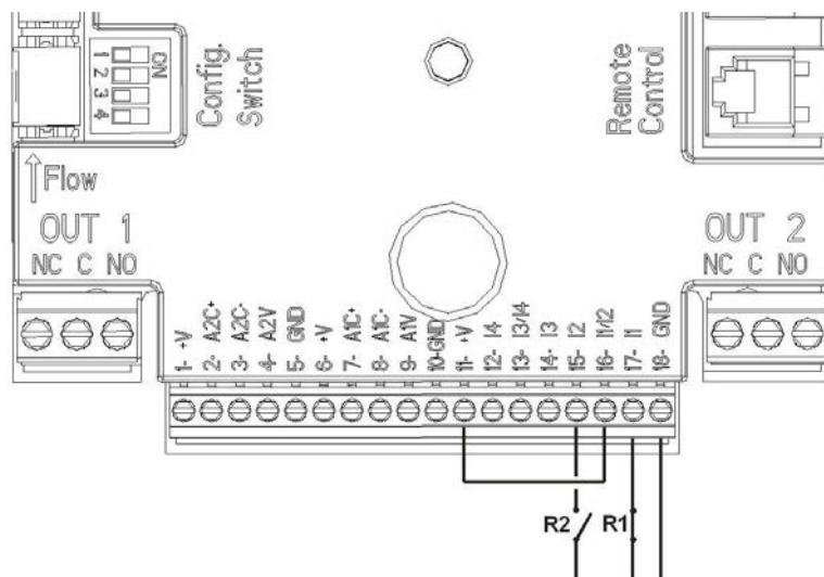
Figura 4: Exemplu de Conexiune Intrări Digitale Start/Stop și Economyy
