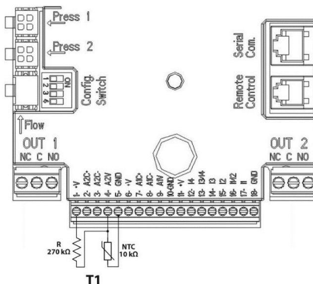
Figure 7: Connexion du capteur CTN pour mesurer la température T11
