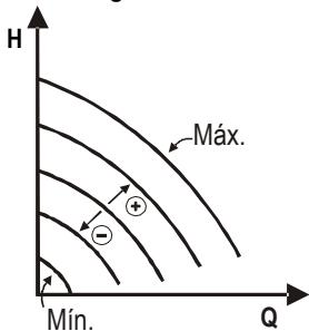
Se mantiene la velocidad de rotación con un número de revoluciones constante. Es posible configurar dicha velocidad de rotación entre un valor mínimo y la frecuencia nominal de la bomba de circulación (por ej., entre 15 Hz y 50 Hz).
