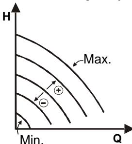
Rotationshastigheten hålls vid ett jämt varvtal. Denna rotationshastighet kan ställas in mellan ett min. värde och cirkulationspumpens märfrekvens (t.ex. mellan 15 och 50 Hz).
