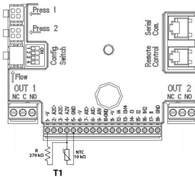
Obrázek 7: Propojení NTC čidla na měření teploty T1
