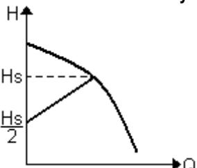
Bu ayarlama yönteminde diferansiyel basınç, su talebinin azalmasına veya artmasına göre azaltılır veya artırılır.
