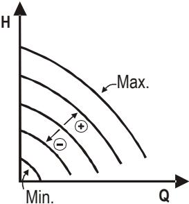
Rotasyon hızı, sabit devir sayısında tutulur. Söz konusu rotasyon hızı, bir minimum değer ve sirkülasyon pompasının nominal frekansı arasında ayarlanabilir (örn. 15 Hz ile 50 Hz arası).
