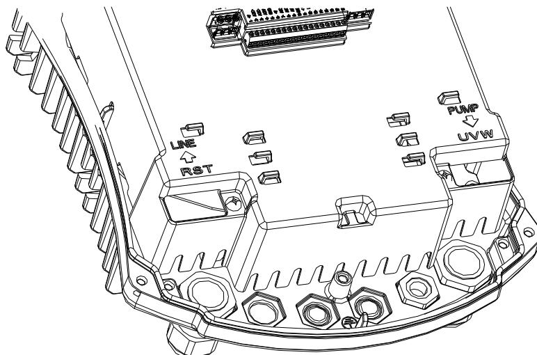
Obrázek 1: Elektrické zapojení
