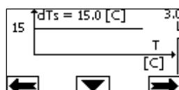
В този случай циркулационната помпа увеличава или намалява дебита, за да поддържа постоянна абсолютната разлика между  $T$  и  $T1$  при  $dTs = 15^\circ C$
