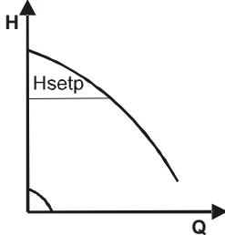
Dopravní výška zůstává stejná, bez ohledu na požadavek vody.
