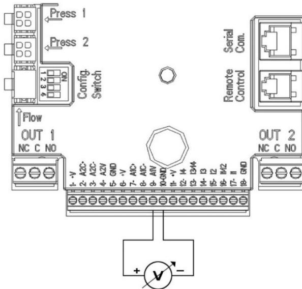
Фиг. 6: Пример на свързване на аналоговия вход
