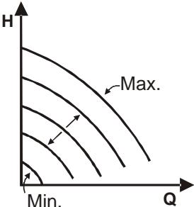
Die Drehgeschwindigkeit wird auf einer konstanten Drehzahl gehalten, die proportional zur Spannung des externen Analogsignals ist (siehe Abs.5.5.2). Die Drehgeschwindigkeit variiert linear zwischen der Nennfrequenz, wenn  $V_{in} = 10V$  und der Mindestfrequenz der Pumpe, wenn  $V_{in} = 0V$ .
