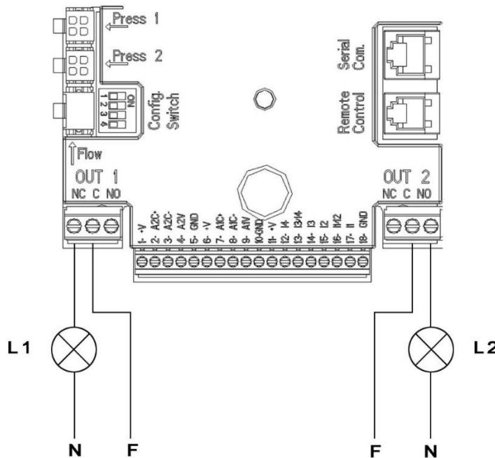
Figure 9: Exemple connexion sorties logiques
