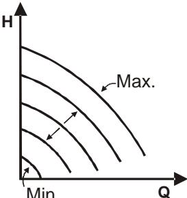
Viteza de rotare este menținută la un număr de rotații constant proporțional cu tensiunea semnalului analogic extern (a se vedea paragraful 5.5.2). Viteza de rotare variază în mod linear între frecvența nominală a pompei când  $V_{in} = 10V$  și frecvența minimă când  $V_{in} = 0V$ . Această modalitate poate să fie setată prin intermediul panoului de control amplasat pe capacul MCE-55/C (a se vedea paragraful 9).
