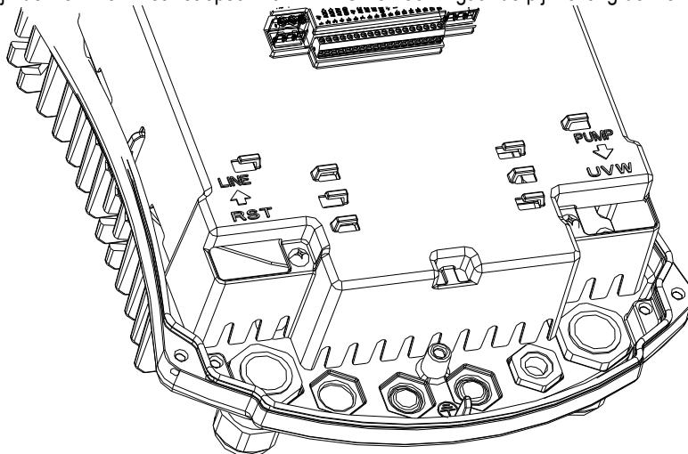
Afbeelding 1: Elektrische aansluitingen
