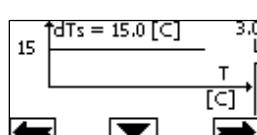
In dit geval verhoogt of verlaagt de circulatiepomp het debiet om het absolute verschil tussen  $T$  en  $T_1$  constant te houden op  $dTs = 15^\circ\text{C}$ .
