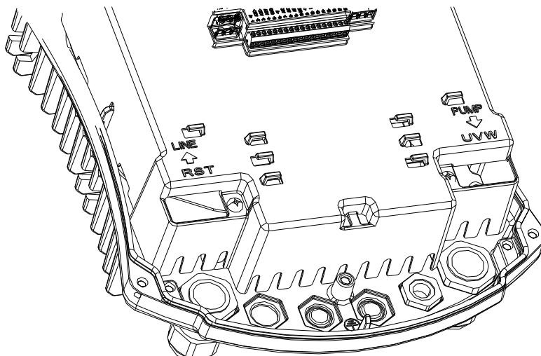
Slika 1: Električni priključki
