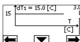
I detta fall ökar eller minskar cirkulationspumpen flödet för att upprätthålla den absoluta skillnaden mellan  $T$  och  $T1$  jämnt på  $dTs = 15^\circ C$ .
