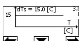
Ilyen esetben cirkulátor csökkenti vagy növeli a folyadékmennyiséget, így konstans marad a  $dTs = 15^{\circ}\text{C}$ . T alatt, a T és T1 közötti abszolút különbség értendő.
