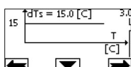
Dans ce cas, le circulateur augmente ou diminue le débit pour maintenir constante la différence absolue entre T et T1 à  $dTs = 15^{\circ}\text{C}$ .
