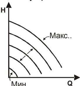
Скоростта на въртене се запазва постоянна, пропорционално на големината на напрежението на аналоговия сигнал (виж пар. 5.5.2). Скоростта варира по линеен закон между ограничителната честота на помпата когато  $V_{in} = 10V$  и минимална честота когато  $V_{in} = 0V$ .
