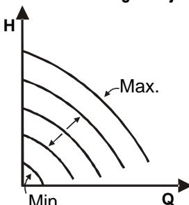
Rotationshastigheten hålls vid ett jämt varvtal som är proportionellt med den externa analoga signalens spänning (se kap. 5.5.2). Rotationshastigheten varierar linjärt mellan pumpens märfrekvens när  $V_{in} = 10$  V och min. frekvens när  $V_{in} = 0$  V.
