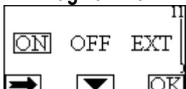
Op pagina 11.0 kan het systeem in de status ON, OFF of EXT (bediend door een signaal van afstand) worden gebracht (Digitale ingang I1).
