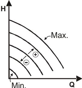
Viteza de rotație este menținută la un număr de rotații constant. O astfel de viteză poate fi setată între o valoare minimă și frecvența pompei de circulație (de ex. între 15 Hz și 50 Hz). Această modalitate poate să fie setată prin intermediul panoului de control amplasat pe capacul MCE-55/C (a se vedea paragraful 9).
