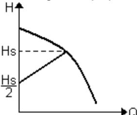
V tomto regulačním režimu se diferenční tlak snižuje nebo zvyšuje podle snížení nebo zvýšení požadavku vody.
