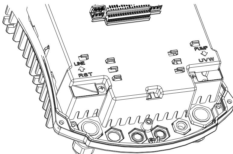
Figure 1: Connexions électriques
