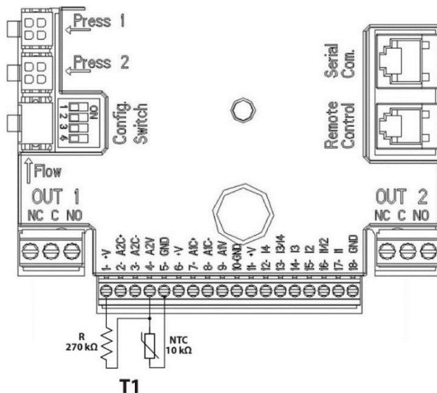
Figura 7: Collegamento sensore NTC per misura temperatura T1
