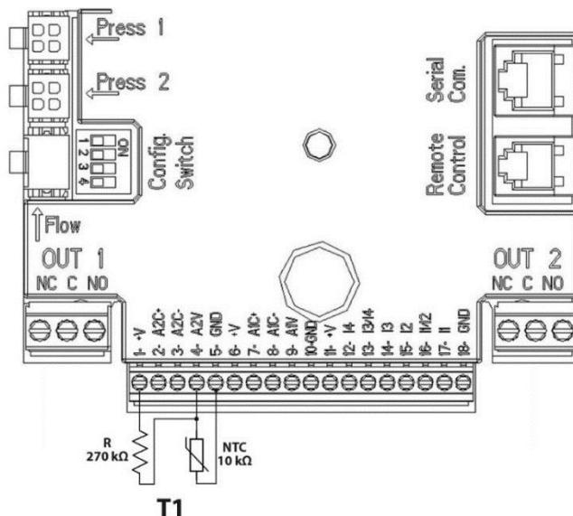
Slika 7: Povezava senzorja NTC za merjenje temperature T1
