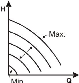
Rychlosť otáček je udržována na konstantním počtu proporcionálním napětím externího analogového signálu (viz § 5.5.2). Rychlosť otáček se liší v lineárním režimu mezi jmenovitou frekvencí čerpadla, když  $V_{in} = 10$  V a minimální frekvencí, když  $V_{in} = 0$  V.
