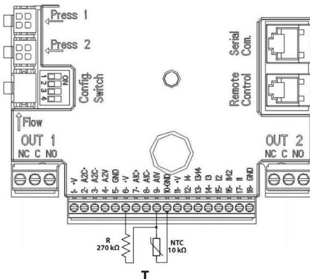
Obrázek 8: Propojení NTC čidla na měření teploty  $T$
