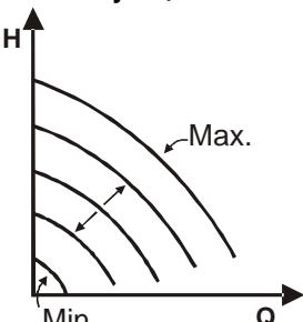
Скорость вращения поддерживается постоянным числом оборотов пропорционально напряжению внешнего аналогового сигнала (см. параг. 5.5.2). Скорость вращения варьирует линейно от номинальной частоты насоса, когда  $V_{in} = 10$  В, и минимальной частотой, когда  $V_{in} = 0$  В.
