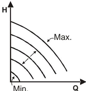
De draaisnelheid wordt op een constant toerental gehouden, proportioneel aan de spanning van het externe analoge signaal (zie par. 5.5.2). De draaisnelheid varieert lineair tussen de nominale frequentie van de pomp wanneer  $V_{in} = 10V$  en de minimumfrequentie wanneer  $V_{in} = 0V$ .
