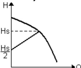
Ebben a szabályzási módban a vízigény csökkenésének vagy növekedésének függvényében a differenciálnyomás csökkentésre vagy növelésre kerül.
