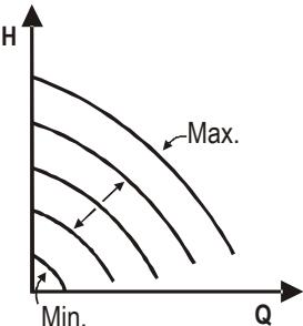
Rotasyon hızı, dış analog sinyalin gerilimine orantılı olarak sabit devir sayısında tutulur (bakınız par. 5.5.2). Rotasyon hızı,  $V_{in} = 10V$  olduğunda pompanın nominal hızı ve  $V_{in} = 0V$  olduğunda minimum frekans arasında lineer şekilde değişir.
