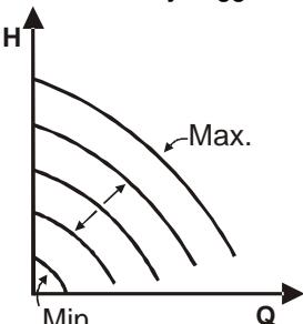
A fordulatszám olyan állandó értéken van tartva mely arányos a külső analóg jel feszültségével (lásd: 5.5.2 fejezet). A fordulatszám lineárisan változik a szivattyú névleges frekvenciája (amikor  $V_{in}=10V$ ) és a minimális frekvencia szerinti fordulatszám között (amikor  $V_{in}=0V$ ).
