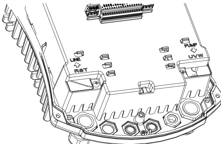
Figura 1: Connessioni Elettriche
